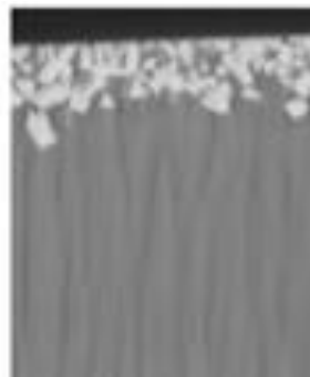
施工条件の異なるWC-Ni硬質皮膜断面組織の電子顕微鏡画像
