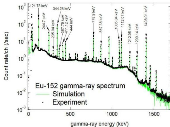
実測及びシミュレーションで計算したガムマ線スペクトル。高精度な放射線シミュレーションが可能です
