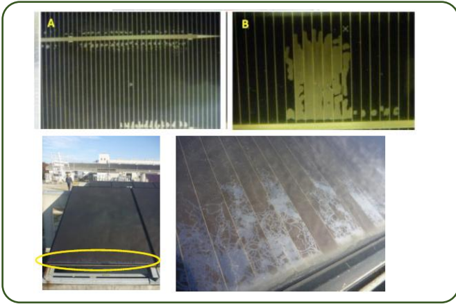
剥離型PIDを起こした太陽電池の外観
