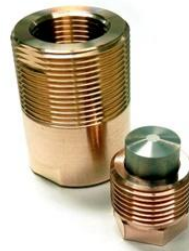
開発中のブリッジマンアンビルセル（～12万気圧）
