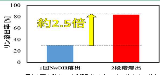
図1 1回NaOH溶出と2段階溶出とのリン溶出率の比較
