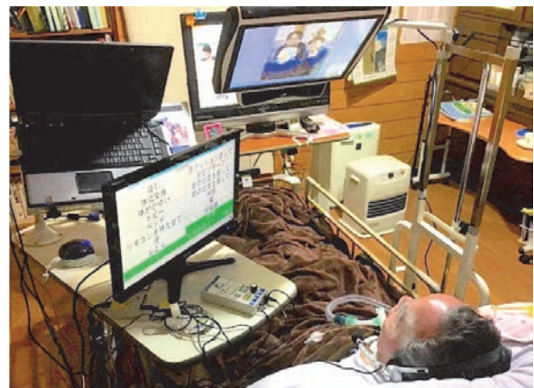
図1 ALS患者のコミュニケーション支援例：視線入力装置、意思伝達装置、環境制御装置
