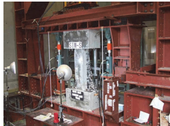
構造物の静加力実験装置とS小の柱を再現した試験体
