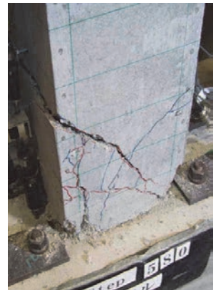
再現された試験体の損傷(右)
