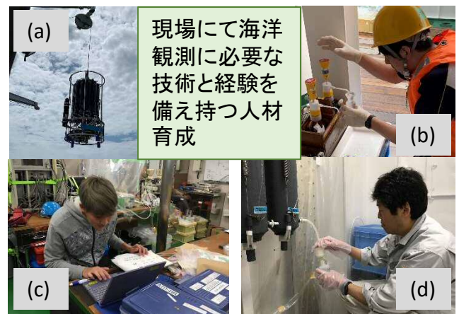
図1. (a) クリーンCTD採水法, (b) 溶存酸素の分析前処理, (c) 深度データ解析, (d) 超微量元素用海水試料のろ過採取
