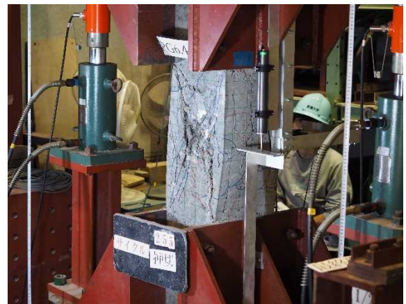
鉄筋コンクリート柱の破壊実験
