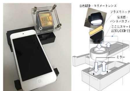
図2. スマートフォン取り付け型 T-SPRセンシングシステムの概略図
