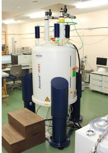
核磁気共鳴装置 Nuclear Magnetic Resonance (NMR) は、磁場中に置かれた原子核とラジオ波の共鳴現象を観測することで、**物質の分子構造を原子レベルで解析**するための装置です。※溶液試料に特化した装置です。
