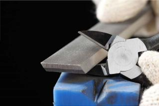
マルト長谷川の技術の中でも最も特徴的なのが、薄く鋭利な刃を加工する技術です。ミクロン単位の精度で機械加工を行った刃を更に1個ずつ職人が手作業で調整していきます。その切れ味は非常に鋭利で、切断面を綺麗に仕上げる事が出来ます。
