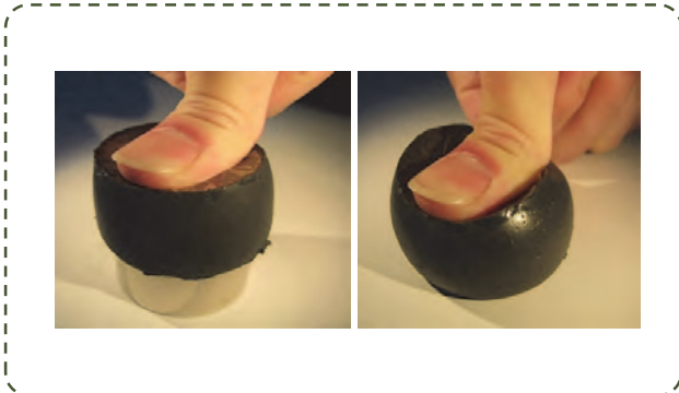
磁石の上におくと指で押しても硬くてへこまない(写真左)。磁石からはずすと、もとの柔らかいゴムに戻る(写真右)。日経産業新聞掲載記事より
