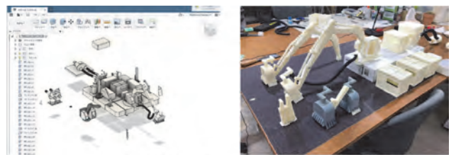
3Dソフト 3Dプリンターを用いた検証模型制作
