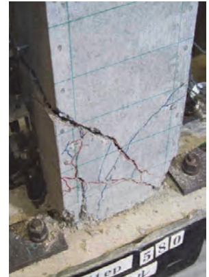
再現された試験体の損傷(右)
