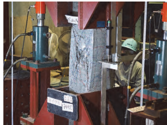
鉄筋コンクリート柱の破壊実験
