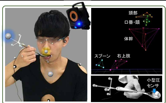
光学的三次元動作解析システム(VICON)と口唇の圧センサシステムの統合
