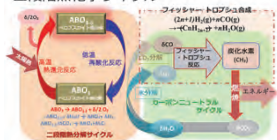
太陽集光熱のクリーンな化学エネルギー転換する ペロブスカイトの酸化還元系を反応媒体とした二段階熱化学サイクル
