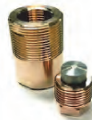
開発中のブリッジマンアンビルセル (～12万気圧)
