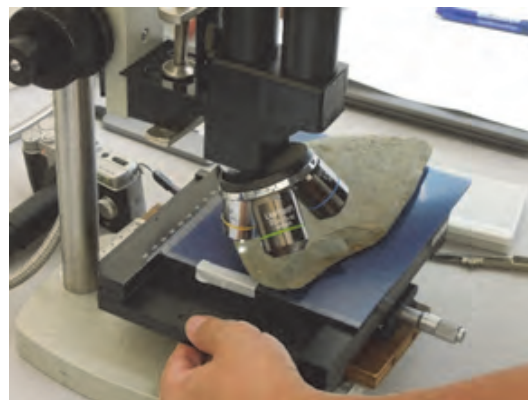
考古資料に対する使用痕分析（モリテックスSOD-Ⅲ）
