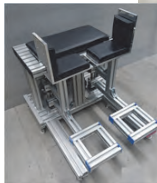
図1: 小型化および機能集約化した 高齢者向けトレーニングマシン
