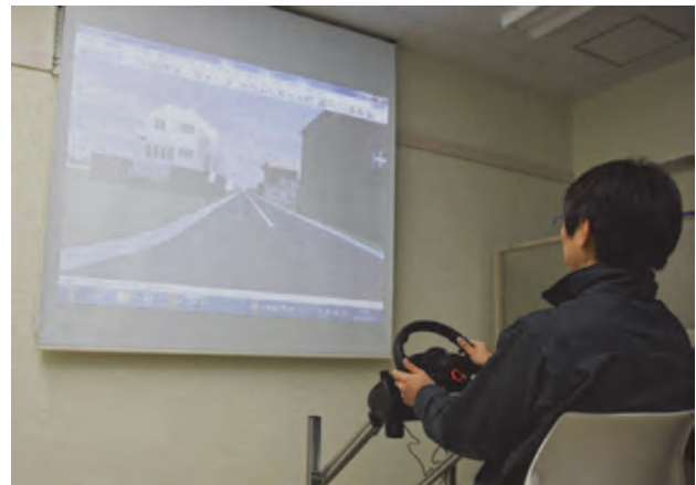
図1: ドライブシミュレータを用いた運転行動計測
