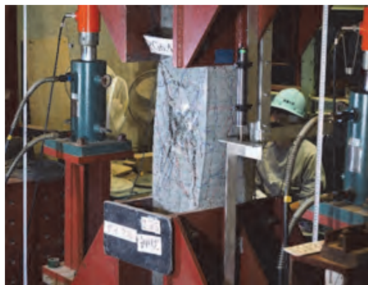
鉄筋コンクリート柱の破壊実験
