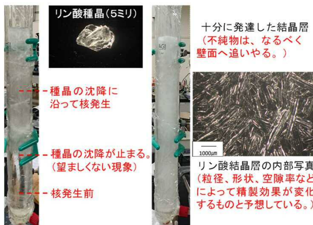
回分冷却晶析塔を用いた粗製リン酸の分離精製
