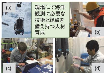
図1. (a) クリーンCTD採水法, (b) 溶存酸素の分析前処理, (c) 深度データ解析, (d) 超微量元素用海水試料の過採取
