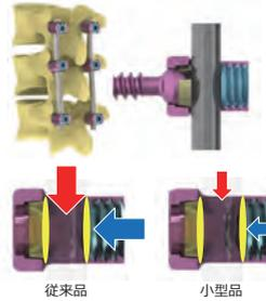
図1 高摩擦係数表面による小型化の例
