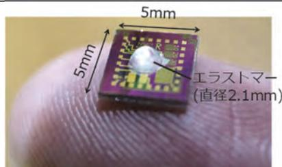
図1 試作した触覚センサチップ
