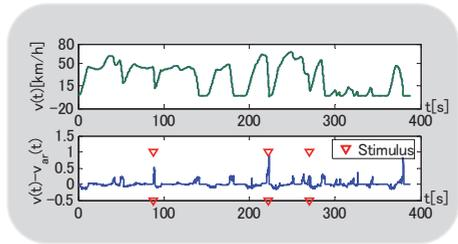
図2:飛び出し刺激への対応行動の検出
