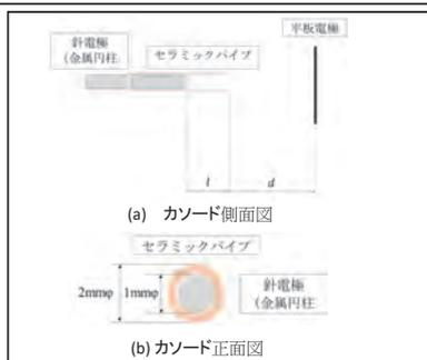
図1 セラミック被覆カソードの概略図
