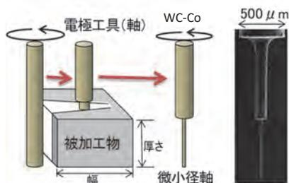
放電加工を用いた微小径軸成形法
