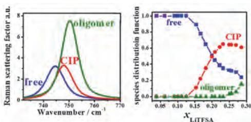
図1. LITFSA水溶液の溶媒のピークの解析結果
