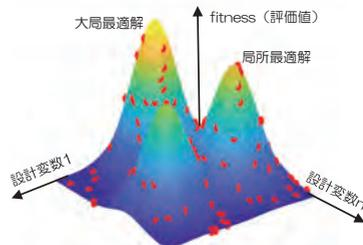
進化計算の最適化探索。複数の探索解（小さな円点）の fitness（評価値）を基に、最適化アルゴリズムに基づいて徐々に最適性能の設計解を探索。
