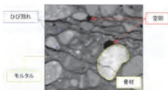
図2 X線CTによる凍害損傷が可視化・定量化
