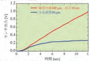
★上図により、100 Pa程度気圧が低下しましたが、平面閉空間構造の故に、圧力変化に対するセンサ応答を変えることができます
