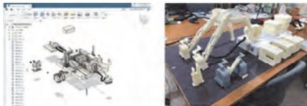
3Dソフト 3Dプリンターを用いた検証模型制作
