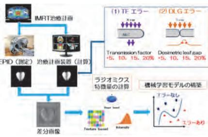
ラジオミクスと機械学習を用いた強度変調放射線治療(IMRT)エラーの自動検出のアウトライン
