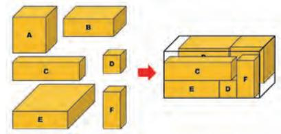
直方体パッキング: 長方形パッキングの3次元版。VLSIの設計だけでなく、倉庫への荷物の詰め込みなどの応用もある。ただし、3次元の場合は直方体が何に対応しているのかによって、様々な制約条件(重ねてはいけない、隣に置いてはいけないなど)が加わる人が多い。
