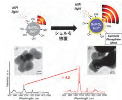
図 GdPO<sub>4</sub>: 3 mol% Nd<sup>3+</sup>コアとGdPO<sub>4</sub>: 3 mol% Nd<sup>3+</sup>/CaPOコアシェル蛍光体のTEM画像と発光スペクトル
