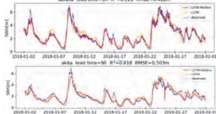
図-2 LSTMマルコフ連鎖による波高予測。観測値(青線)と機械学習を用いた予測値(赤線)がよく一致している。(西田ら, 2021)
