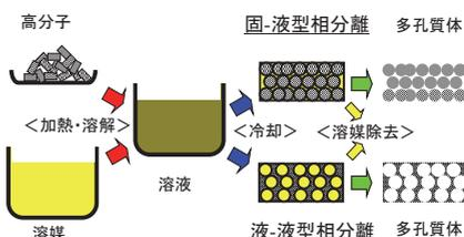
相分離法による多孔質高分子材料の作製
