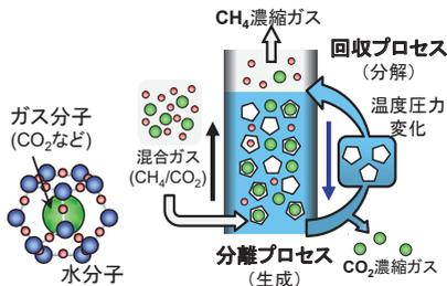
図1 ハイドレートの構成 図2 CO<sub>2</sub>連続回収プロセスの概要
