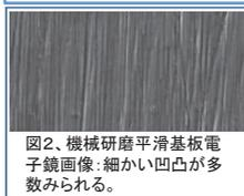
図2、機械研磨平滑基板電子鏡画像：細かい凹凸が多数みられる。
