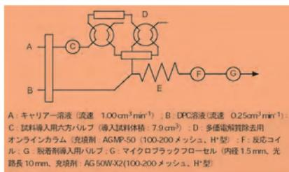
A: キャリア溶液 (流速 1.00cm<sup>3</sup>min<sup>-1</sup>); B: DPC溶液 (流速 0.25cm<sup>3</sup>min<sup>-1</sup>); C: 試料導入用六方バルブ (導入試料体積: 7.9cm<sup>3</sup>); D: 多電極電位除去用オンラインカラム (充填剤: AGMP-50 (100-200メッシュ、H<sup>+</sup>型)); E: 反応コイル; F: 検出器導入用バルブ; G: マイクロフラクフローセル (内径1.5mm, 光路長10mm, 充填剤: AG50W-X2(100-200メッシュ、H<sup>+</sup>型))
