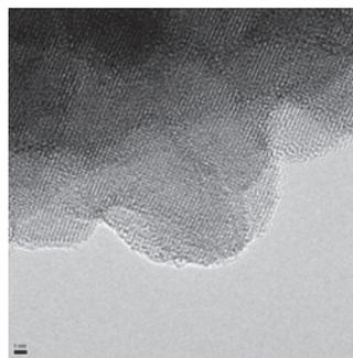
WASSR法を用いて合成した $\text{BaTiO}_3$ の電子顕微鏡像関連する
