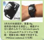
3次元の加速度計、重量計、使用者の動きを測定し、精度が十分に認められているCole-KripkeもしくはSadehのアルゴリズムで睡眠・覚醒を高い精度で判定する。（MAGNet websiteより引用）
