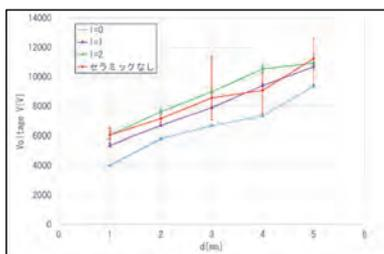
図2 放電開始電圧特性
