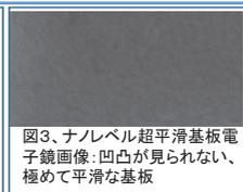
図3、ナノレベル超平滑基板電子鏡画像：凹凸が見られない、極めて平滑な基板
