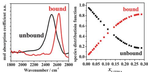
図2. LITFSA水溶液のアニオンのピークの解析結果
