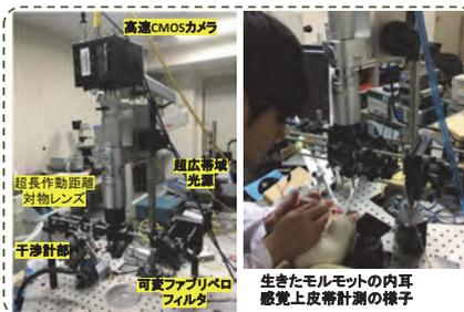
図1 MS-OCM装置構成とin-vivo実験の様子
