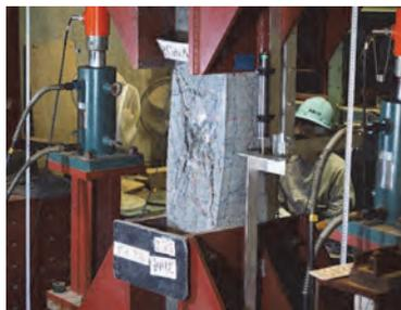
鉄筋コンクリート柱の破壊実験
