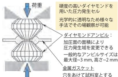
圧力発生技術のひとつーダイヤモンドアンビルセル
