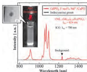
図 Nd<sup>3+</sup>-NASICON蛍光体のTEM画像と発光写真と発光スペクトル
