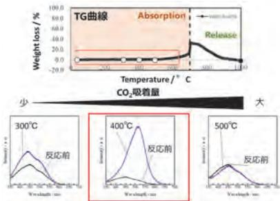
図 Li<sub>4</sub>SiO<sub>4</sub>のTG曲線とCO<sub>2</sub>吸着量ごとの試料の発光スペクトル
