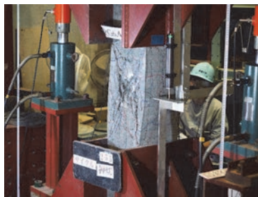
鉄筋コンクリート柱の破壊実験
