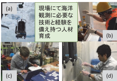
図1. (a) クリーンCTD採水法, (b) 溶存酸素の分析前処理, (c) 深度データ解析, (d) 超微量元素用海水試料のろ過採取
