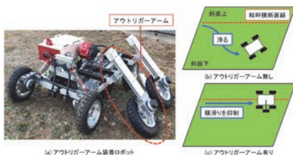
図1 アウトリガーアーム装着ロボットの概要
