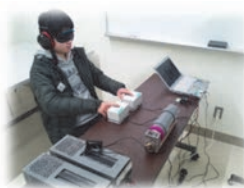
図1: 指先触覚の弁別実験
