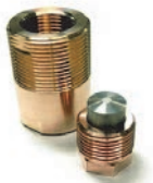
開発中のブリッジマンアンビルセル (～12万気圧)
