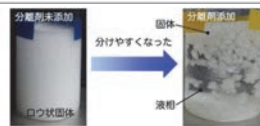
実験例：パラミチン酸メチル質量濃度と曇り点変化(0.5wt%添加)
