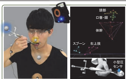
光学的三次元動作解析システム(VICON)と口唇の圧センサシステムの統合
