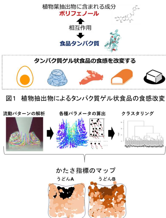
図2 食感の新たな機器計測法の開発（うどんの解析例）
